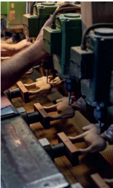
Die Rohlinge der Krippenfiguren werden maschinell hergestellt (links), geschnitzt und bemalt wird anschliessend von Hand (rechts), hier durch Franziska Venrath.
